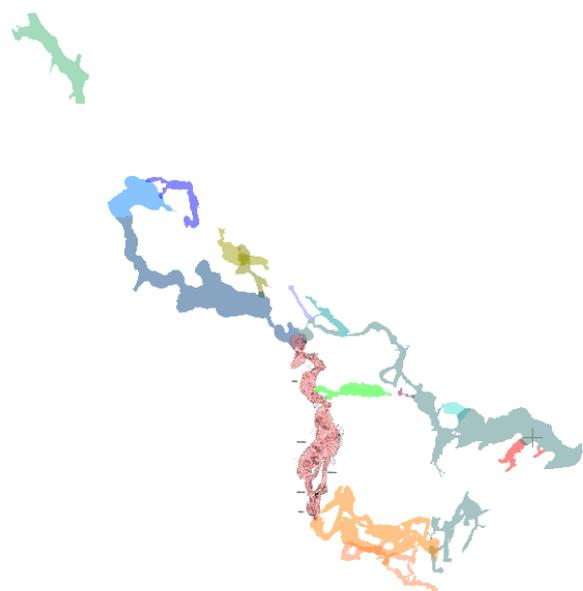
Lo stesso disegno con filtrato solo un ramo. In modalità 'combinata' sono comunque visibili le altre parti della cavità. Questa funzione permette di avere, mentre si disegna, un riferimento dimensionale per rendere la parte correntemente visibile conforme con le parti nascoste.
